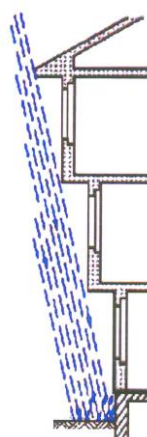
Protezione grazie alla sporgenza del tetto e a un'altezza adeguata del basamento
