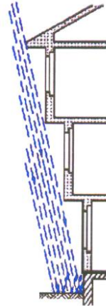
Schutz durch Dachüberstand und ausreichende Sockelhöhe
